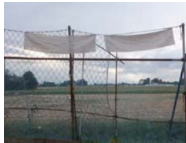
リネン吸着法はリネン布を貫通して通過する風速はほぼゼロ。
