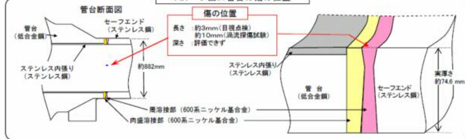
Aループ出口管台の傷の位置
