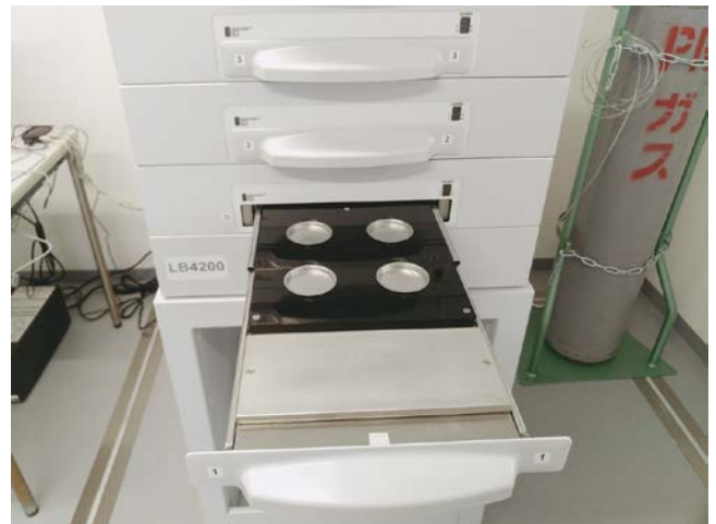
測定器LB4200。16検体同時計測が可能のため、年間500名ほどの乳歯が測定できる予定
