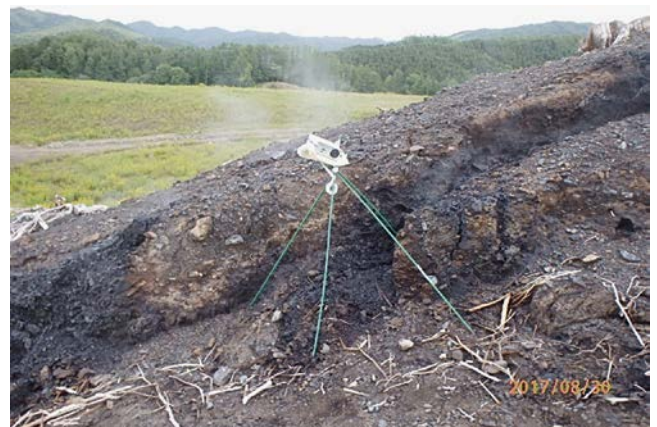
自然発火しているズリ山での測定の様子
