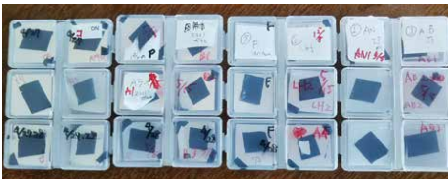
柔軟剤を使用したクロスサンプル。クロス上に付着した微小粒子状物質を電子顕微鏡で分析する
