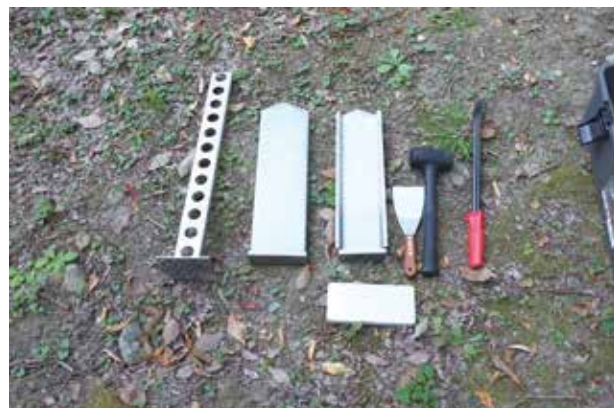
ジオスライサーの一式。二つの金属のフレームを組み合わせ、地面にハンマーで打ち込むことで、土壌の鉛直方向のサンプルを切り出すもの。
